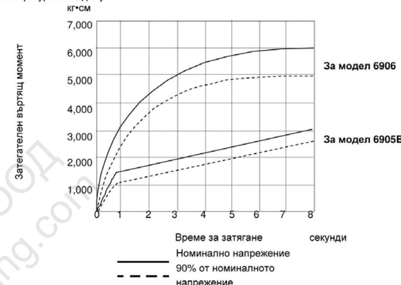
Дръжте инструмента здраво и фиксирайте накрайника върху болта или гайката. Включете инструмента и затягайте в продължение на правилното време за затягане.
